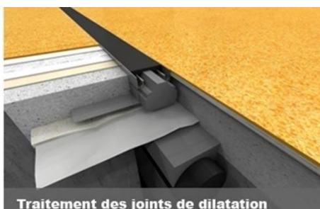
Traitement des joints de dilatation
